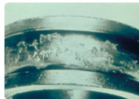
Stufe 4: Bei zu langem Betrieb schält sich die gesamte Laufbahn; die ursprüngliche Beschädigung ist nicht mehr sichtbar.
