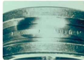
Stufe 3: Die Verunreinigungen werden überrollt, es entwickelt sich eine echte Oberflächenschälung.
