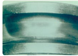
Stufe 1: Auf der Oberfläche entwickelt sich eine feine Rauheit oder Welligkeit.
