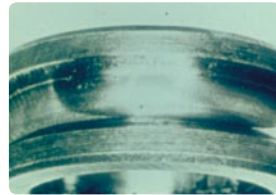
Stufe 2: Oberflächenspannungen und kleine Risse entstehen. Dann treten Mikroschälungen auf.
